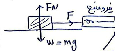
بلکچوبی را از یک پایه روی سطح افقی قرار می دهیم. نیروی سنج را به بلکچوب وصل کرده و سر دیگر نیروسنج را در دست گرفته و می کشیم. وقتی جسم بر آستانه لغزیدن قرار می گیرد عددی که نیروسنج نشان می دهد نیروی استاتیکی است.
